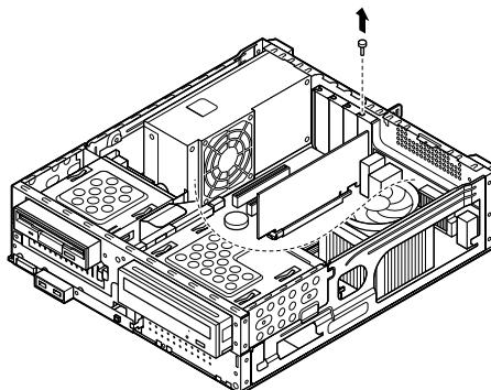
**3 PCI Express x16スロットのロックを矢印①の方向にスライドさせてロックを解除する**
