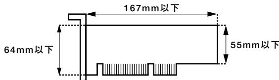
搭載可能なPCIボードサイズは、ハーフサイズ(Low Profile)の64(W)mm
