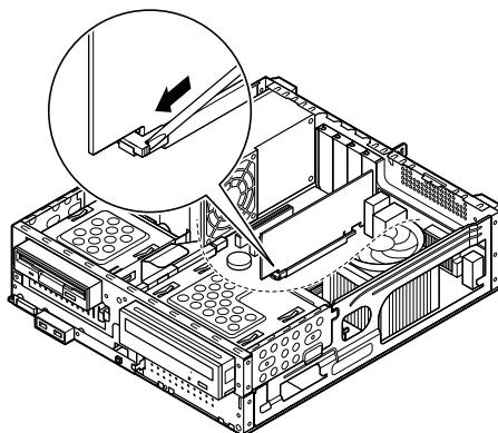
**4 PCI Express x16ボードをI/Oプレート側から引き抜くようにして取り外す**
