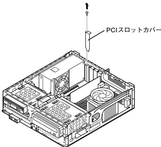
**3** 手順2で取り外したネジでPCIボードを取り付ける
