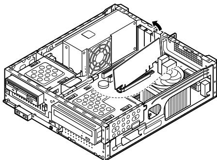
**5** 工場出荷時に取り付けられていたPCI Express x16スロットカバーを、手順2で取り外したネジで取り付ける
