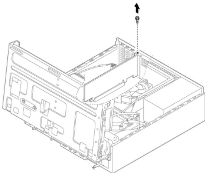
**3** PCI Express x16スロットのレバーを横に押しながら、PCI Express x16ボードを図のようにして取り外す
