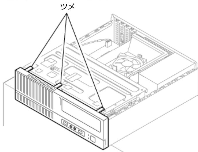
**3** フロントマスクを倒すように開きながら、下の方にあるツメを外し、本体から取り外す
