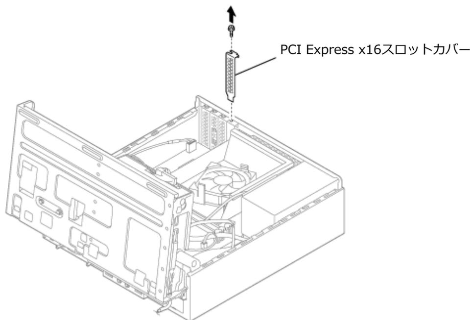
**3** PCI Express x16ボードをPCI Express x16スロットに差し込み、手順2で取り外したネジを取り付けてPCI Express x16ボードを固定させる
