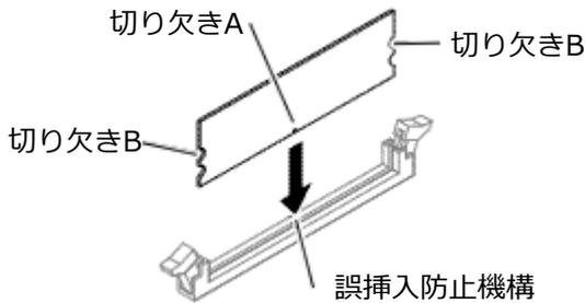
**5** 左右2か所のレバーが切り欠きBに掛かるように、メモリをしっかりと押し込む
