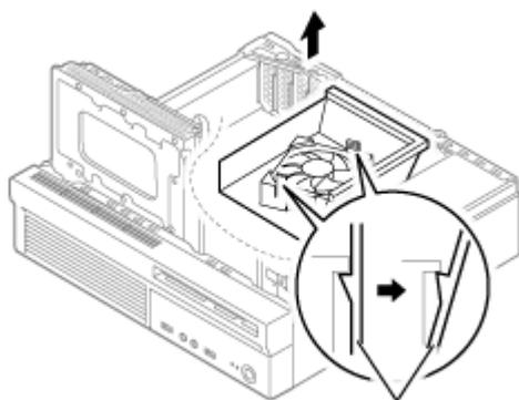
4 ケーブルストッパの長い方のツメを図の向きに押し、ケーブルストッパとケーブルを本体から取り外す
