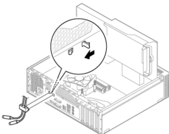
5 ファンダクトを図の向きにしてネジ穴の位置を合わせ、ファンダクトを取り付ける
