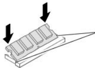
メモリを押し込むとき、この部分が左右に開き、メモリがロックされると元の位置に戻ります。
