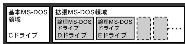
領域の削除は、論理MS-DOS ドライブ 拡張MS-DOS領域 基本MS-DOS領域の順に削除してください。領域の作成は、逆に基本MS-DOS領域 拡張MS-DOS領域 論理MS-DOS領域の順で作成してください。
