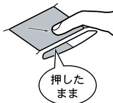
アイコンやフォルダの上にポインタを乗せた状態で、パッドに2回続けて触れ、2回目に触れたときにパッドから指を離さずにスライドさせてもドラッグできます。
