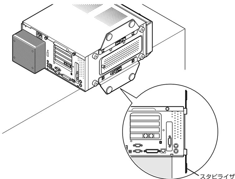
5 ボトムカバーのネジを反時計回りにまわしてゆるめる
