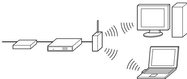
ブロードバンドを利用するときは、パソコンとネットワーク機器をLANケーブルで接続します。ワイヤレスLANを使うと、この部分のケーブル接続が不要になります。
