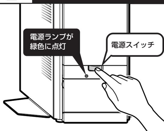
❗ 電源スイッチを押しても、電源ランプが点灯しない場合、電源ケーブルが正しく接続されていないことが考えられます。第2章の「電源ケーブルを接続する」(36ページ)をご覧ください。
