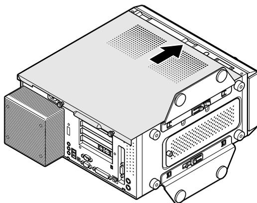
**3** 本体左側面のサイドカバーのネジを時計回りにまわして固定する
