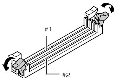
**8** 切り欠き ㊦ の方向とコネクタのミゾの位置が合うように、空いているコネクタにボードを垂直に差し込む
