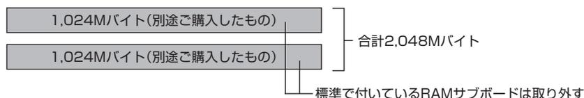
デュアルチャネルとは、同容量/同タイプの2枚のRAMサブボードに同時にアクセスすることで、メモリのデータ転送性能を約2倍に高速化する技術のことです。
