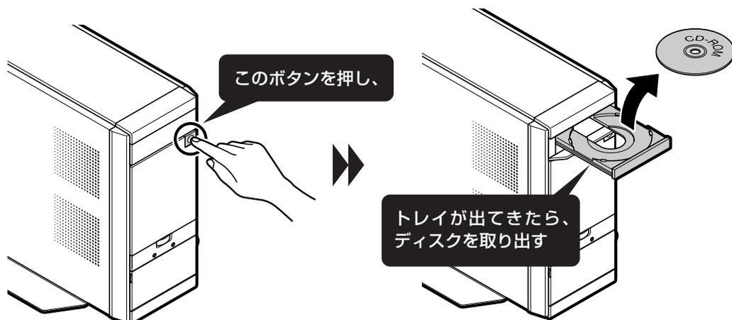
ディスクを取り出したら、トレイを軽く押すか、イジェクトボタンを押してください。トレイが収納されてカバーが閉じます。
