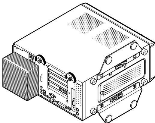
**4** 「サイドカバーの外し方」の手順3で取り外したケーブルをもとどおりに取り付ける
