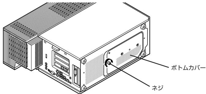
7 ボトムカバーを本体背面方向に少しずらしてから、手前に倒すようにして取り外す
