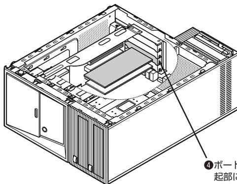
④ ボードの切り欠きが本体の突起部に合っているか確認する
