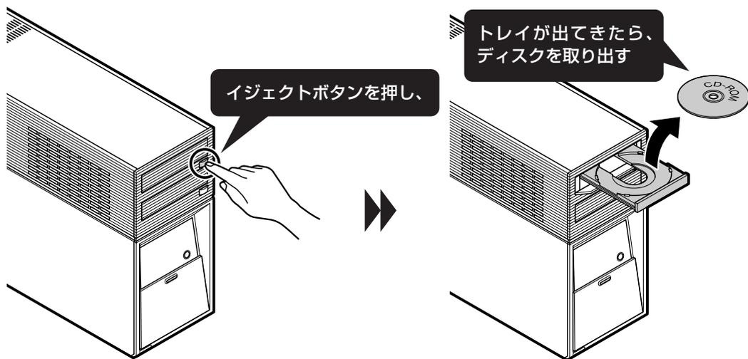
ディスクを取り出したら、トレイを軽く押すか、イジェクトボタンを押してください。トレイが収納されてカバーが閉じます。
