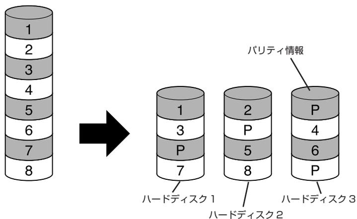
RAID5の構成で使用中に、停電や電源コンセントの引き抜き、電源ボタン長押しによる強制終了といった不意の電源断が起こると、直後の再起動でRAID ボリュームのパリティ初期化がおこなわれる場合があります。これはハードディスクの故障ではありませんが、パリティ初期化の完了を待ってご使用ください。
