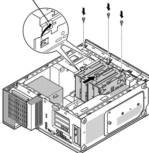
**7** ハードディスクの電源ケーブルと信号ケーブルを図のように取り付ける
