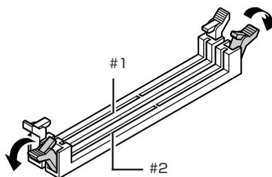
9 切り欠き ㊦ の方向とメモリスロットにあるミゾの位置が合うように、空いているスロットにボードを垂直に差し込む
