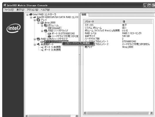
「RAID 以外のハードドライブ」配下に表示されているハードドライブを右クリックし、「このハードドライブに再構築」、または「スペアとしてマーク」を選択します。画面の指示にしたがってRAIDの再構築をおこなってください。それでも、再構築できない場合は、次の「再セットアップしてRAIDを再構築する」をご覧ください。
