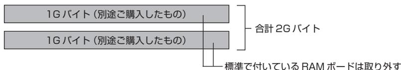
デュアルチャンネルとは、同容量/同タイプの2枚のRAMボードに同時にアクセスすることで、メモリのデータ転送性能を約2倍に高速化する技術のことです。
