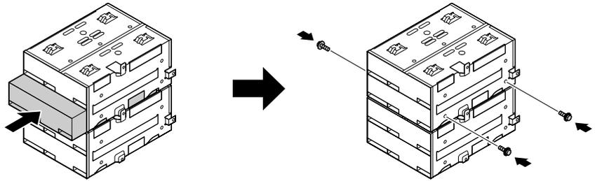
**6** 手順3と逆の手順でハードディスクブラケットを取り付けて、取り外したネジ3本で固定する
