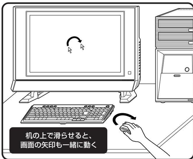
このマウスは、マウス底面から出ている赤い光をセンサーが検知して、動きを判断します。濃淡のはっきりした模様や柄のないところ、光沢や反射のないところで使うと、センサーが光を検知しやすく、快適に動きます。
