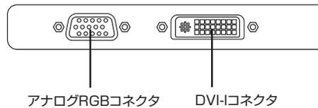
※ GシリーズでDVIカードを搭載したモデルを選んだ場合、スロットのコネクタはDVI-Dコネクタになります。また、GeForce 6200 TCを搭載したモデルを選んだ場合、スロットのコネクタは、DVI-Iコネクタになります。
