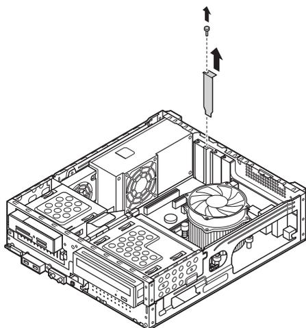
**5** PCI Expressボードをスロットに差し込み、外したネジで取り付ける
