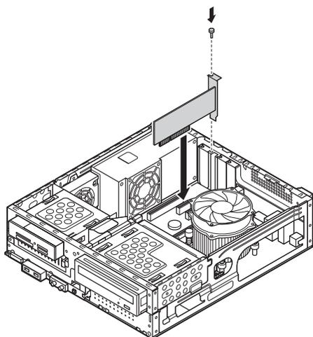
PCI Express(×16)ボードを取り付ける場合には、抜け防止ロック機構をスライドさせて、ボードを固定してください。
