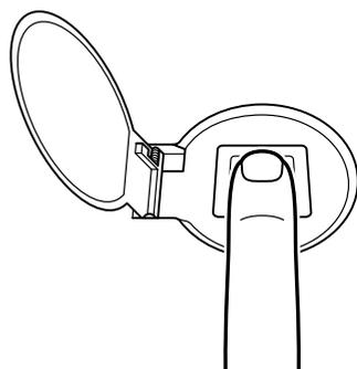
爪の付け根の位置とセンサの中心が重なり、正しい位置に置いているように見えますが、この状態を真上や横から見ると、右の図のように爪の付け根がセンサの中心から手前にずれていて、正しい位置にないことがわかります。
