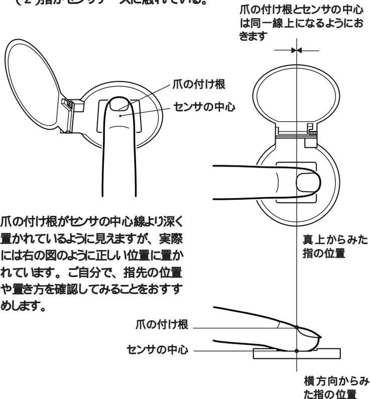
爪の付け根がセンサの中心線より深く置かれているように見えますが、実際には右の図のように正しい位置に置かれています。ご自分で、指先の位置や置き方を確認していただくことをおすすめします。
