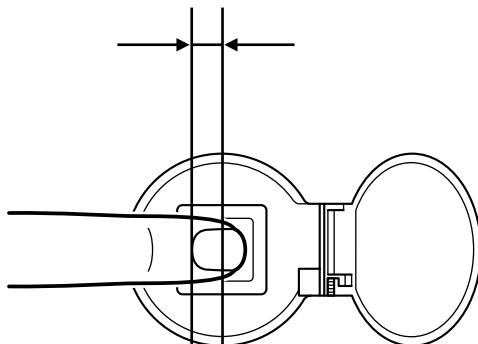
爪の付け根の位置とセンサの中心が重なり、正しい位置に置いているように見えますが、この状態を真上や横から見ると、右の図のように爪の付け根がセンサの中心から手前にずれていて、正しい位置にないことがわかります。
