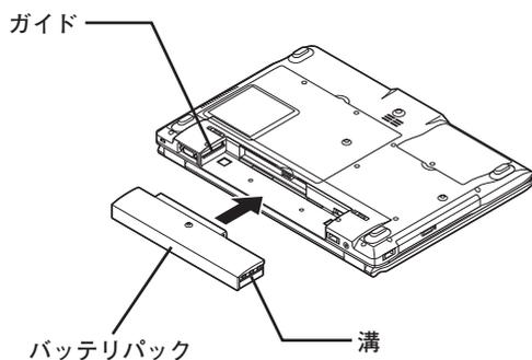
④ バッテリージェクトロックを矢印の方向にスライドさせ、バッテリーパックをロックする
