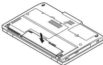
④ バッテリージェクトロックを矢印の方向にスライドさせ、バッテリーパックをロックする
