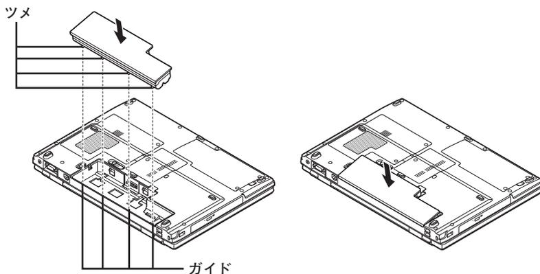
④ バッテリージェクトロックを矢印の方向にスライドさせ、バッテリーパックをロックする
