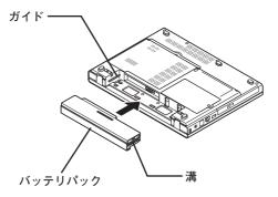
介が、テリイジェクトロックを矢印の方向にスライドさせ、バッテリパックを ロックする
