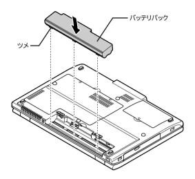
7 バッテリパックを矢印の方向にゆっくりと押し込み、カチッと音が するまでしっかり取り付ける
