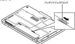
5 バッテリアンロックを矢印の方向にスライドさせ、バッテリパック を持ち上げて取り外す
