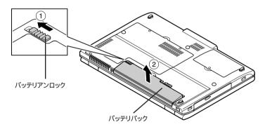
6 新しいバッテリパックの底面のツメを本体のツメにひっかけて、 取り付ける 取り付けるときは、バッテリパックの向きに注意してください。
