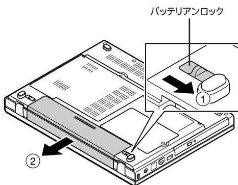
**6** 新しいバッテリーパックの両側の溝と本体のガイドを合わせて、矢印の方向にゆっくりとスライドさせ、カチッと音がするまでしっかり取り付ける
