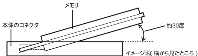
**7 カチッと音がする位置までメモリを本体のコネクタに強く倒し込む**
