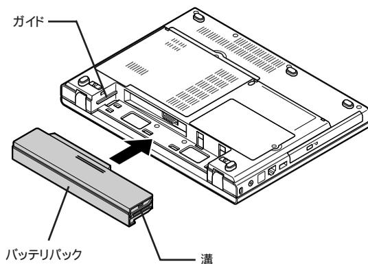
**7** バッテリージェクトロックを矢印の方向にスライドさせ、バッテリーパックをロックする
