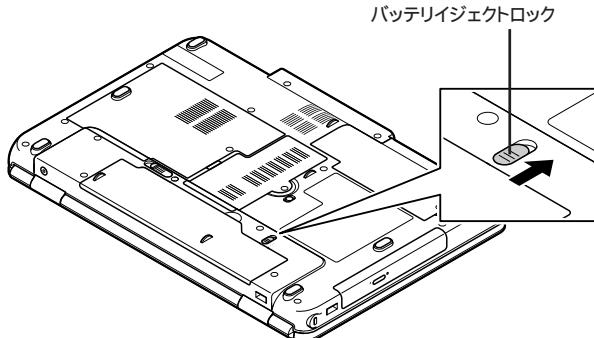
**5 バッテリーアンロックを矢印の方向にスライドさせ、バッテリパックを持ち上げて取り外す**
