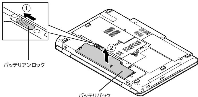
**6 新しいバッテリパックの底面のツメを本体のツメに引っかけて、取り付ける
