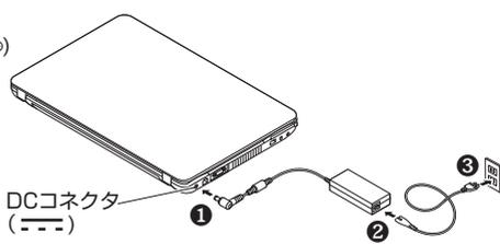
タイプVD、タイプVAの場合、ACアダプタを取り付けると、バッテリーの充電が始まりバッテリー充電ランプ(
