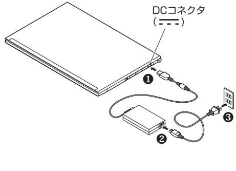
ACアダプタを取り付けると、バッテリーの充電が始まりバッテリー充電ランプ(☐)が点灯します。バッテリーの充電状態によってはバッテリー充電ランプが点灯しない場合があります。これはバッテリーが95%以上充電されているためです。
