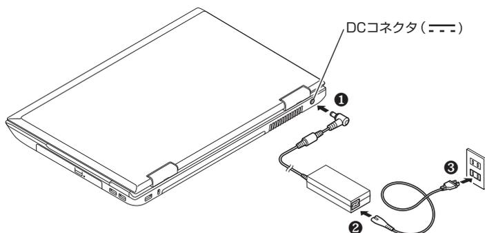
ACアダプタを取り付けると、バッテリーの充電が始まりバッテリー充電ランプ(☐)が点灯します。バッテリーの充電状態によってはバッテリー充電ランプが点灯しない場合があります。これはバッテリーが95%以上充電されているためです。
