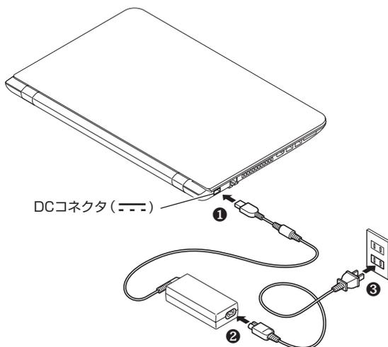
ACアダプタを取り付けると、バッテリーの充電が始まりバッテリー充電ランプ (□) が点灯します。バッテリーの充電状態によってはバッテリー充電ランプが点灯しない場合があります。これはバッテリーが95%以上充電されているためです。
