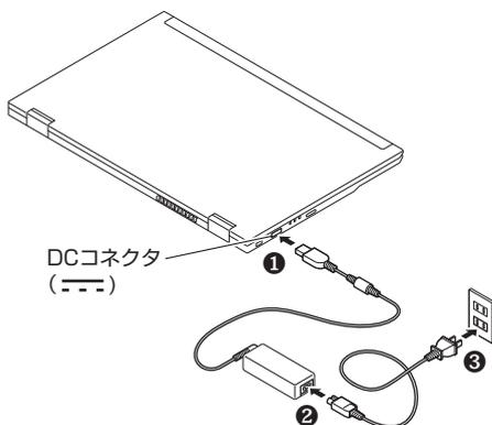
ACアダプタを取り付けると、バッテリーの充電が始まりバッテリー充電ランプ(☐)が点灯します。バッテリーの充電状態によってはバッテリー充電ランプが点灯しない場合があります。これはバッテリーが95%以上充電されているためです。
