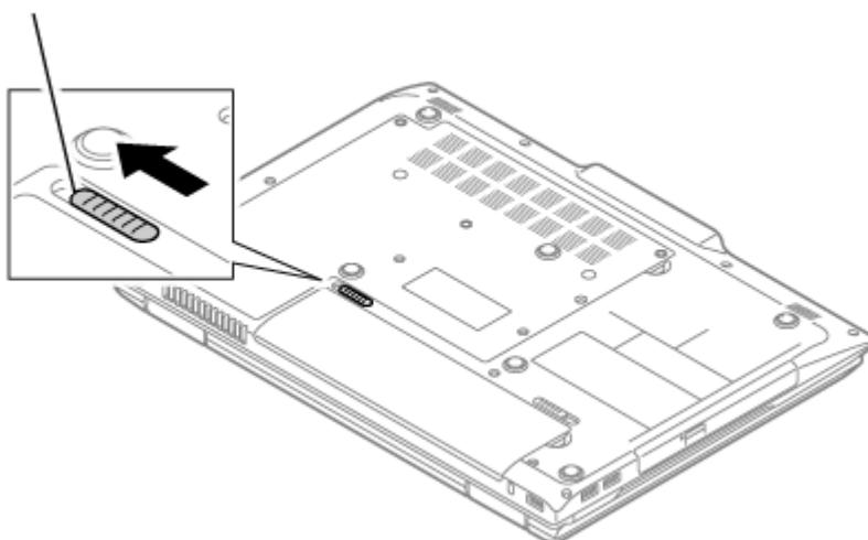
**5 バッテリイジェクトレバーを矢印の方向にスライドさせ、バッテリパックを持ち上げて取り外す**
