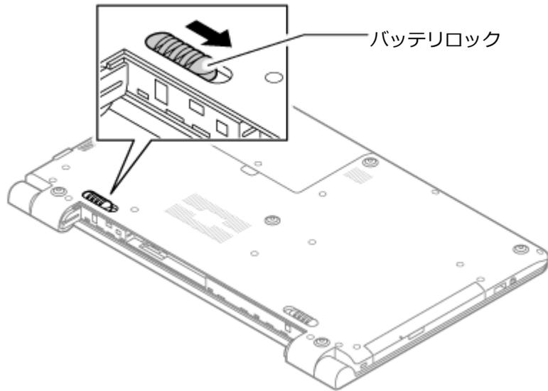
**5** バッテリーパックを矢印の方向にゆっくりと押し込み、カチッと音がするまでしっかり取り付ける
