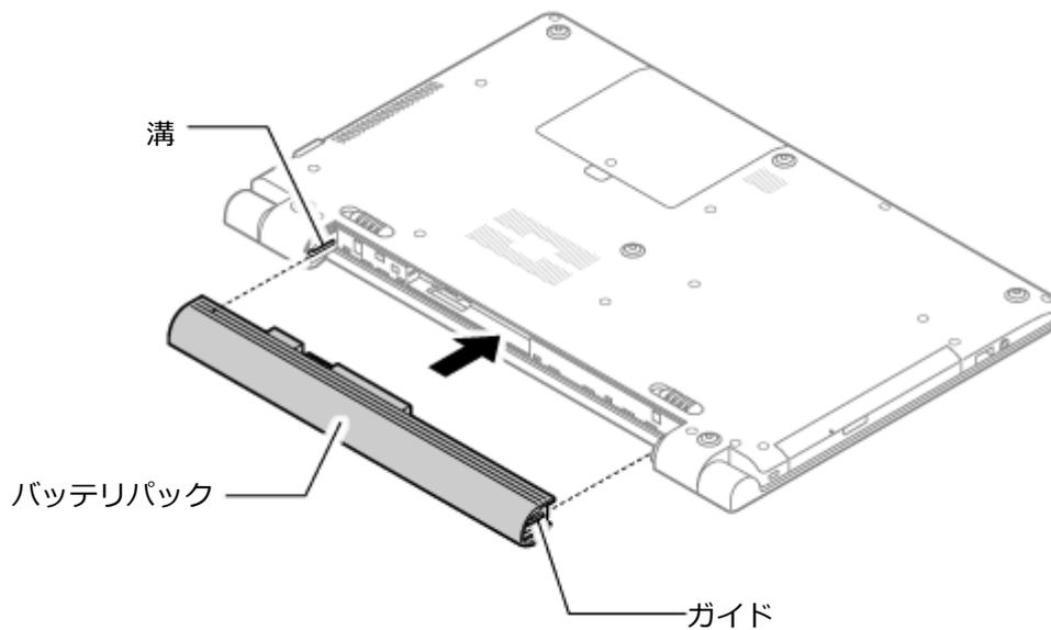
**6** バッテリーロックを矢印の方向にスライドさせ、バッテリーパックをロックする
