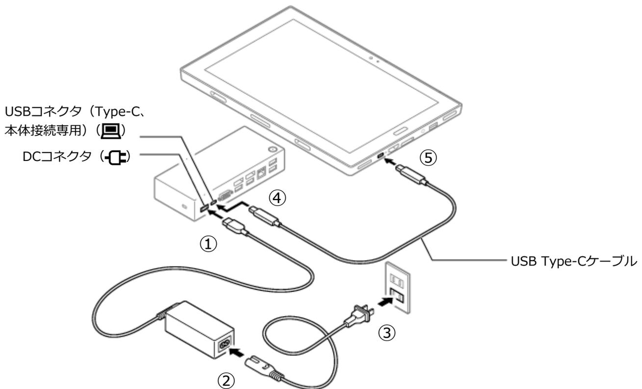
**1** ACアダプタをUSB Type-C ドックのDCコネクタ (DCコネクタ) に接続する
