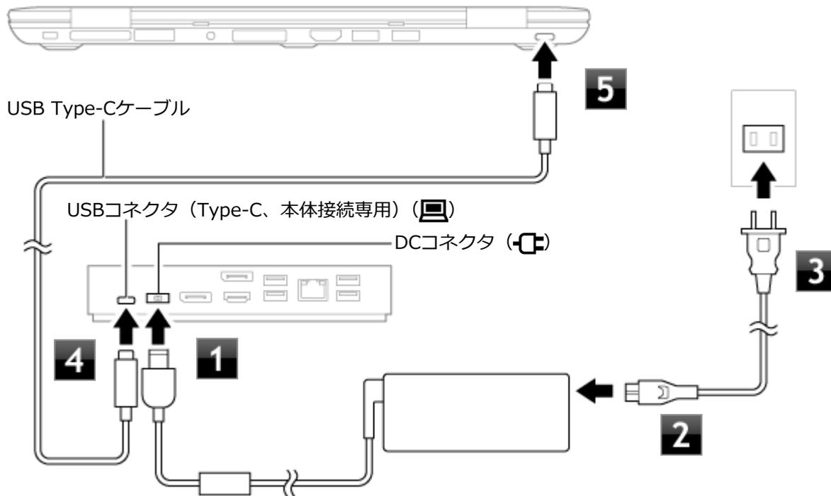
**1** ACアダプタをUSB Type-C拡張ドックのDCコネクタ (☐) に接続する
