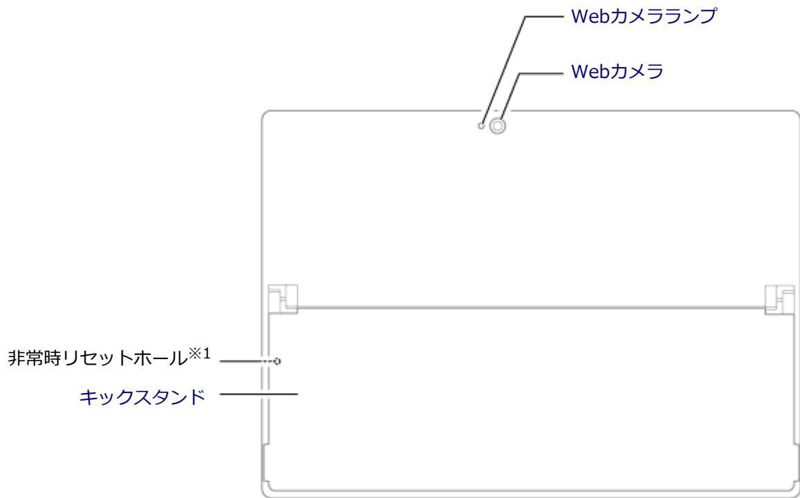
※1 細い針金などで中のボタンを押すと、本機をリセットできます。本機が応答しなくなり、電源スイッチを押し続けても電源を入／切できない場合に、ACアダプタを取り外し、キックスタンドを引き出してから使用してください。
