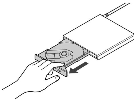
**4** ディスクのデータ面（文字などが印刷されていない面）を下にして、傷など付けないようディスクトレイの中央に置き、ディスクを軸にしっかりはめ込む
