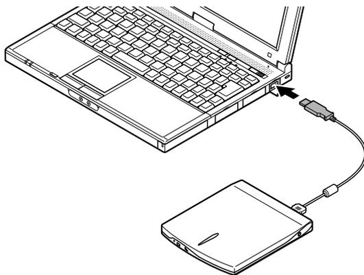
図はUSBコネクタ(ポート3)に接続する場合のものです。USBコネクタへの接続について詳しくは、PART2の「USBコネクタ」( p.237 )をご覧ください。
