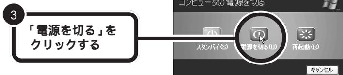
自動的に本体の電源が切れ、操作パネル左上の【TV/PC】ランプのPCの文字のまわり、【PC】ボタンのランプ、電源スイッチのランプが消灯します。
