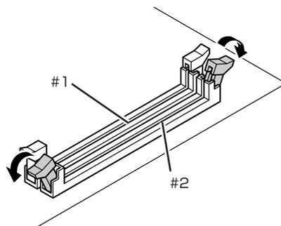
**3** 切り欠き㊦の方向とコネクタの溝の位置が合うように、空いているコネクタにボードを垂直に差し込む
