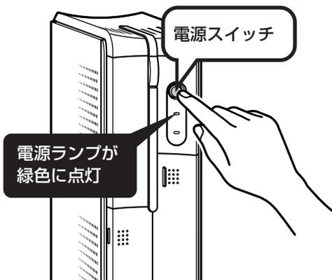
❗ 電源スイッチを押しても、電源ランプが点灯しない場合、電源ケーブルが正しく接続されていないことが考えられます。第2章の「電源ケーブルを接続する」(21ページ)をご覧ください。
