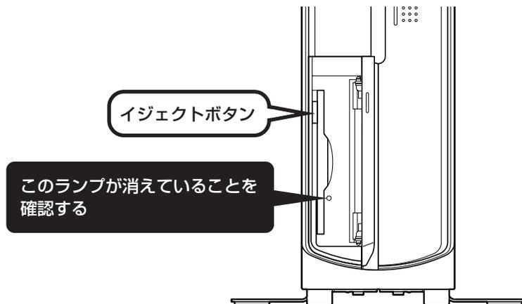
❗ ランプが緑色に点灯しているときは、フロッピーディスクにファイルを保存したり、ファイルを開いたりしている途中であることを示します。ランプの点灯中は、フロッピーディスクを取り出さないでください。フロッピーディスクの内容が破損されることがあります。
