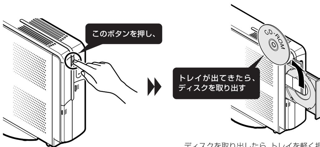
ディスクを取り出したら、トレイを軽く押すか、イジェクトボタンを押してください。トレイが収納されてカバーが閉じます。
