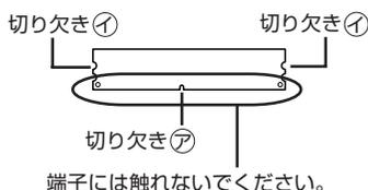
コネクタの溝とボードの切り欠き㊦の位置を確認してから差し込んでください。
