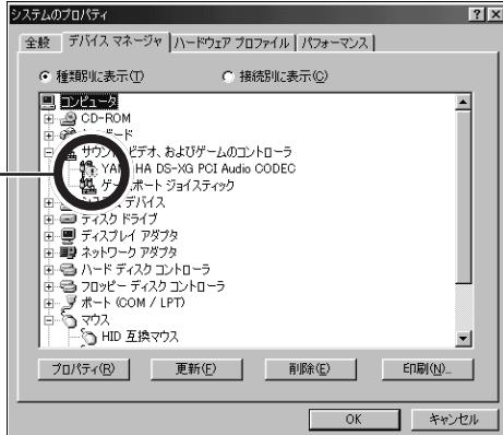
デバイスマネージャを表示したときに、その機器のアイコンに「！」マークや「×」マークが付いていたら、その機器の「プロパティ」を表示してみます。「デバイスの状態」の欄に「競合」を示すメッセージが表示されているら、リソースが競合しています。
