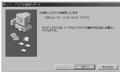
プリンタなどのプラグ&プレイ対応デバイスドライバをインストールした場合は、インストール後、他の操作をせずに、ただちにWindowsを再起動してください。
