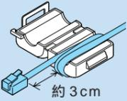
電話機につながっているケーブルを壁のモジュラーコンセントから取り外して、ノイズ除去用部品を取り付ける。ノイズ除去用部品を取り付けたケーブルをパソコン背面の(☎)の付いたコネクタに差し込む。
