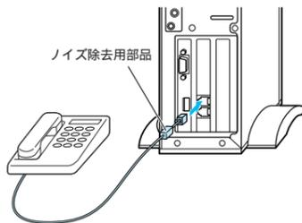
添付のモジュラーケーブルにノイズ除去用部品を取り付ける。ノイズ除去用部品を取り付けた側のプラグをパソコン背面の(☎)の付いたコネクタに差し込み、もう一方のプラグを壁のモジュラーコンセントに差し込む。
