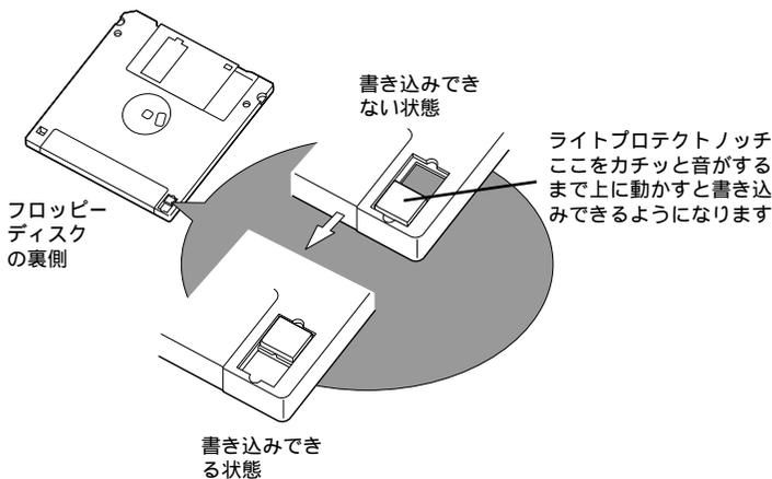
フロッピーディスクには、記録されている内容を間違えて消したり変更してしまわないように、書き込みができないようにする機能(ライトプロテクト機能)があります。ファイルを保存したいときは、ライトプロテクトノッチを書き込みできる方向にずらします。
