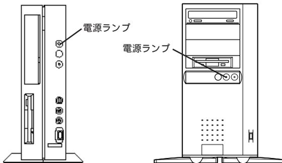
パソコン本体の電源ランプが点灯していないときは、『まずこれ! 接続と準備』PART2の「電源ケーブルを接続する」にしたがって、電源ケーブルを接続し直してください。
