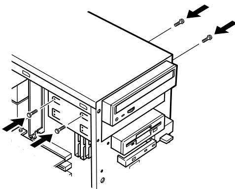
**5** フロントマスクを取り外したときと逆の手順で取り付ける
