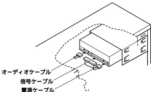
**4** CD-ROM ドライブを押し込み、側面からネジ4本で固定する
