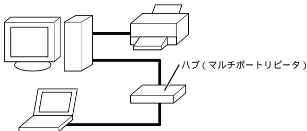
ハブ(マルチポートリピータ)と各パソコンのLAN コネクタを接続します。
