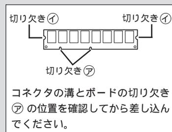
コネクタの溝とボードの切り欠き㊦の位置を確認してから差し込んでください。
