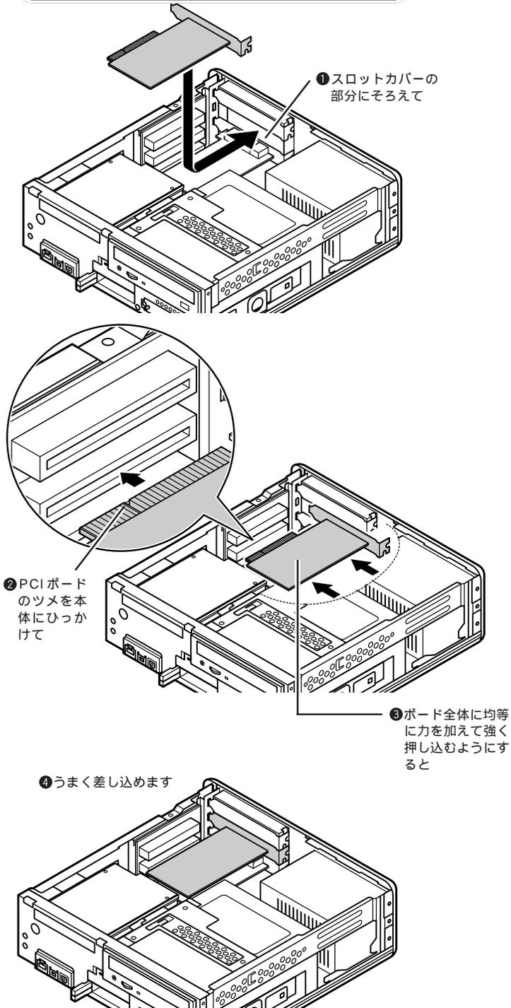
PCIボードをしっかり差し込むには、強い力が必要です。ボードのツメの先端がPCIスロットにきちんと合っていれば壊れることはありませんので、強く押し込むようにしてください。また、そのときに指をぶついたり、切ったりしないように注意してください。
