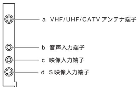
**a VHF/UHF/CATV アンテナ端子 (Y VHF/UHF/CATV)**
