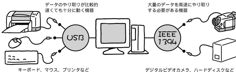
\*1 USBにはUSB1.1とUSB2.0の2種類の規格があり、2.0の方が高速です。ただしp.12で説明しているこのパソコンのコネクタはUSB1.1のみ対応しています。
