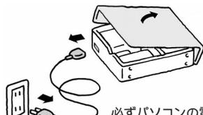
必ずパソコンの電源を切り、電源ケーブルをコンセントから抜く
