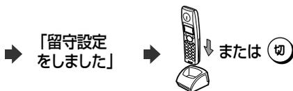
▶ [7]を押す前に「ピーピーピー」と音がしたあと待ち受け中に戻るときは : 親機が使用中です。しばらくしてから操作し直してください。
