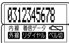
12桁×1行で文字を表示します。何も操作をしていないときは、内線番号が表示されています。
