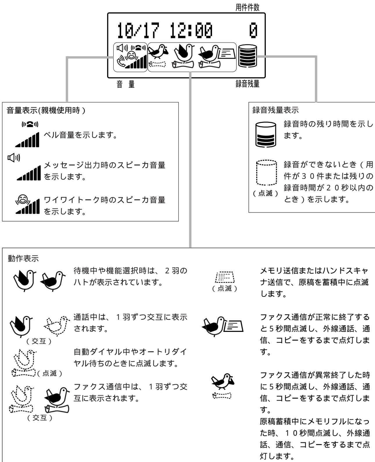
1. バックライトは、機能選択中や、通話、ファクス通信、プリントなどの動作中に点灯し、動作終了後、約3秒で消灯します。
