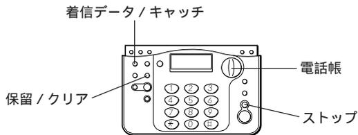
**1** 着信データキャッチを押します。着信した順番 (新しい順) 着信した日時 最新の着信データが表示されます。着信データがないときは「チャクシンデータ アリマセン」と表示されます。
