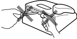
ぬれた手で電源プラグを抜き差ししないでください。漏電して、感電の原因となります。
