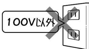
電源プラグおよび子機充電器用ACアダプタはコンセントに確実に差し込んでください。電源プラグの刃に金属などが触れると、火災・感電の原因となります。
