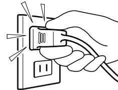
電源プラグはAC 100Vコンセントに差し込んでください。やむを得ず、同じコンセントに他の電気製品の電源プラグを差し込む場合は、電流値の合計がコンセントの最大値を超えないようにしてください。火災の原因となります。
