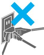
電源プラグおよび子機充電器用 AC アダプタはコンセントに確実に差し込んでください。電源プラグの刃に金属などが触れると、火災・感電の原因となります。
