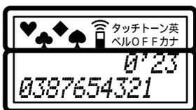
12桁×2行で文字を表示します。何も操作をしていないときは、内線番号が表示されています。
