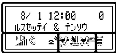
16桁×2行で文字を表示します。何も操作をしていないときは、日時と留守録の件数が表示されています。
