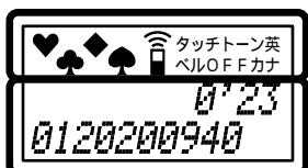
12桁×2行で文字を表示します。何も操作していないときは、内線番号が表示されています。
